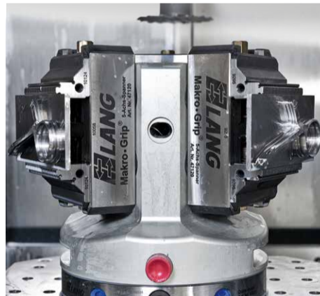
links: Der Arbeitsraum des 5-Achsen-Bearbeitungszentrums C 22 U mit dem Schwenkrundtisch auf dem ein Mehrfach-Spannsystem installiert ist. rechts: Die „Parade“ der 5-Achsen-Bearbeitungszentren C 22 U mit PW 150, C 12 U mit RS 05 und C 40 U im neuen Fertigungszentrum von Fetzer Medical GmbH & Co. KG
